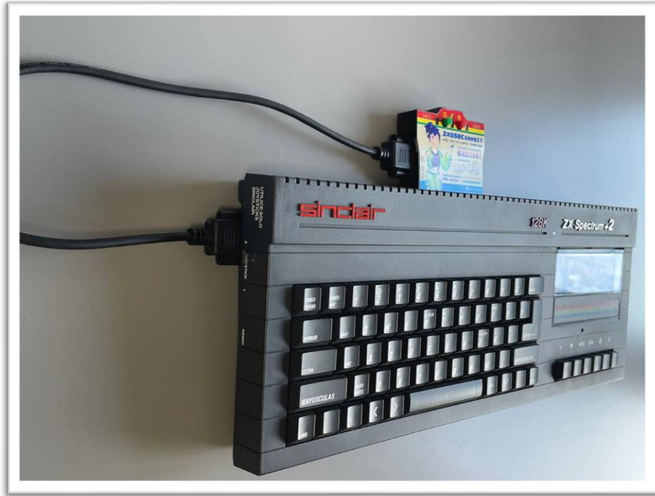
Figura 1: Observa el cable DB9 conectado al puerto del Zx-Spectrum.
