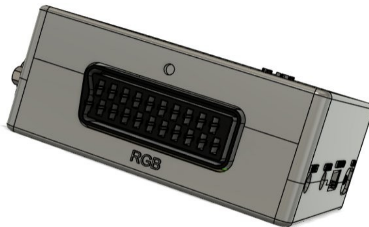
Vista trasera: conector RGB SCART
